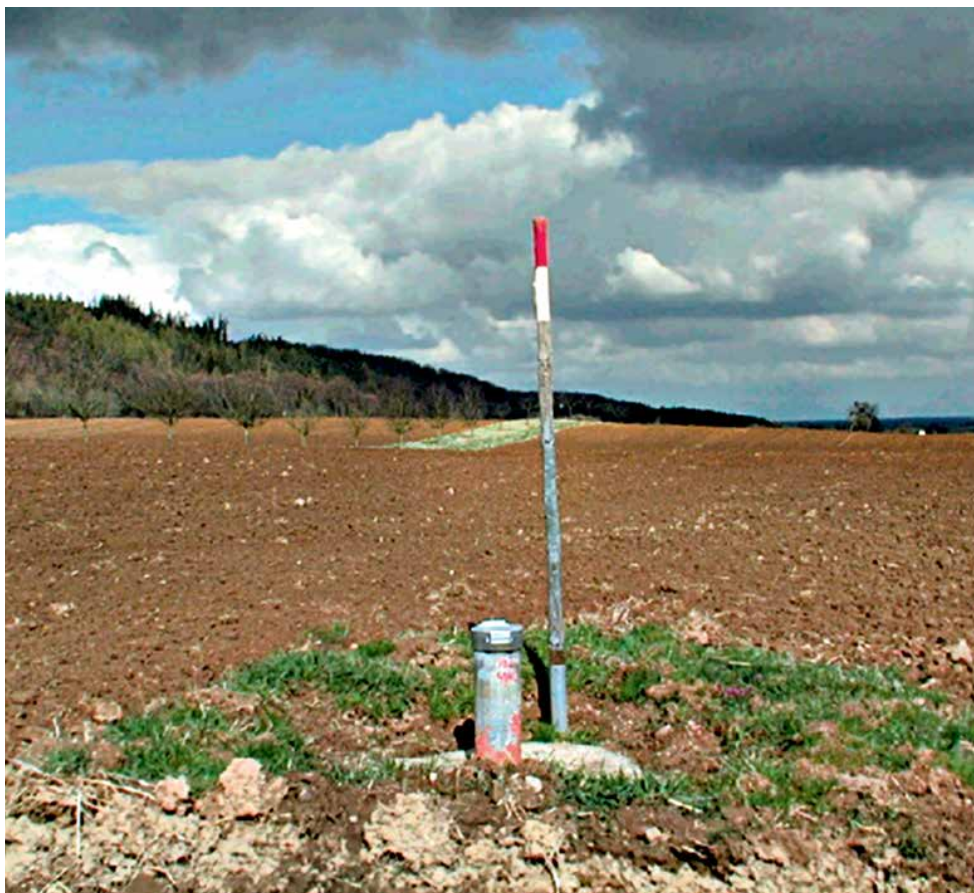
An Grundwassermessstellen werden die Wasservorräte ständig überwacht und die Beschaffenheit des Grundwassers überprüft.
