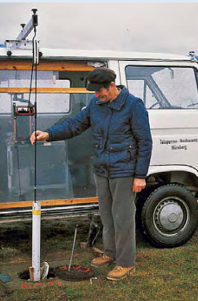
Links: Die Messung der Dammneigung erfolgt auch heute noch wie in den Anfangsjahren mit einem Inklinometer.
