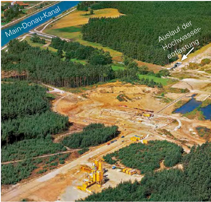
Oben: Bei den Bauarbeiten 1987/88 an der Rothsee-Hauptsperre wurden insgesamt rund 1 Mio. m 3 Erdmaterial bewegt. Heute ist davon kaum noch etwas zu erkennen.
