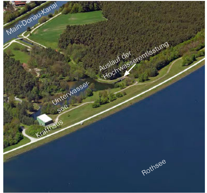
Oben: Bei den Bauarbeiten 1987/88 an der Rothsee-Hauptsperre wurden insgesamt rund 1 Mio. m 3 Erdmaterial bewegt. Heute ist davon kaum noch etwas zu erkennen.
