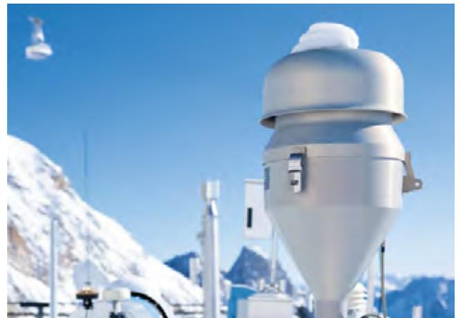
Probeneinlass zur Bestimmung der Partikelmasse
