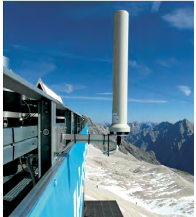
Messgerät zur Bestimmung der Gamma-Ortsdosisleistung.
