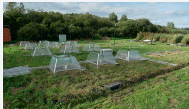
Abb. 60: Open-top-chambers (OTCs) zur passiven Temperatur-Erhöhung im Projekt MOORadapt.
