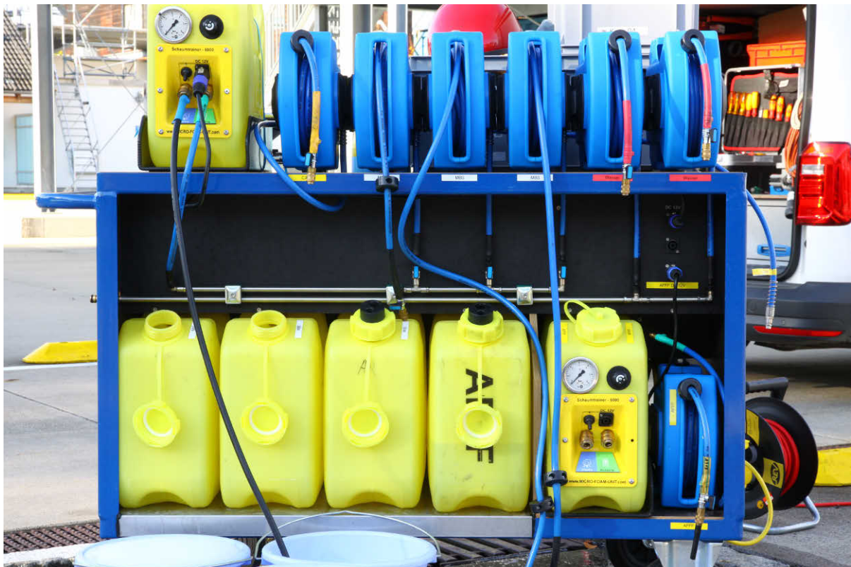
Abb. 33: Schaumtrainer für Übungen im Kleinmaßstab
