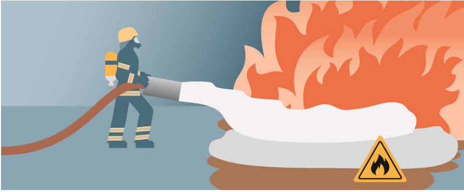
Abb. 25: Indirekte Applikation von Löschschaum durch Aufschieben
