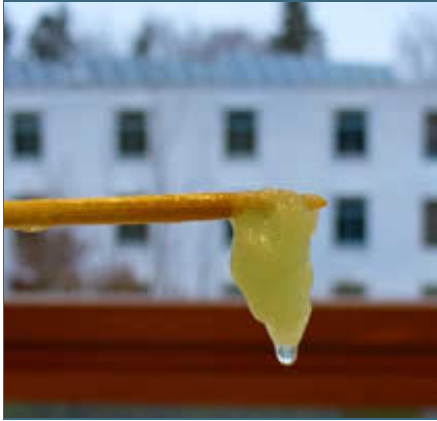
Abb. 22: AFFF-AR reagiert mit Class-A-Schaummittelkonzentrat, die zu beobachtende Gelbildung kann zu Problemen beim Einsatz führen.
