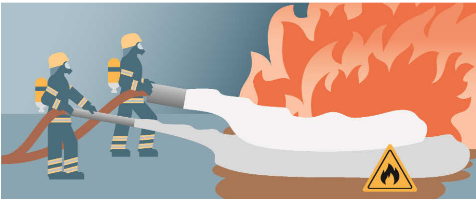
Abb. 26: Indirekte Applikation von Löschschaum durch kombiniertes Aufschieben
