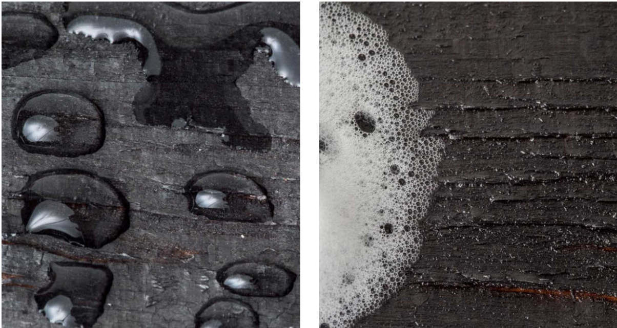
Abb. 14: Linke Seite: Wasser ohne Tenside perlt ab. Rechte Seite: Benetzende und eindringende Wirkung des Löschwassers durch Zugabe von Tensiden
