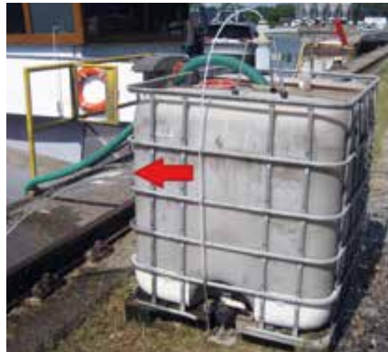
Undichter IBC → Waschwasser versickert auf Hafengelände oder gelangt ins Gewässer
