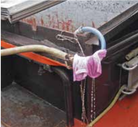
Undichte Schlauchleitungen → Waschwasser gelangt ins Gewässer
