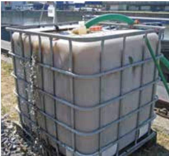
Überlaufen des IBCs → Waschwasser versickert auf Hafengelände oder gelangt ins Gewässer
