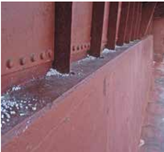
Spanten mit Düngemittelresten
