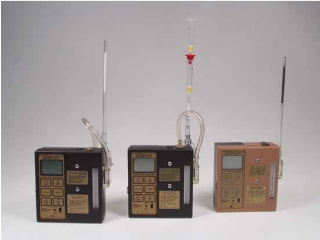
Abbildung 2: Aktive Probenahmesysteme für flüchtige organische Substanzen
