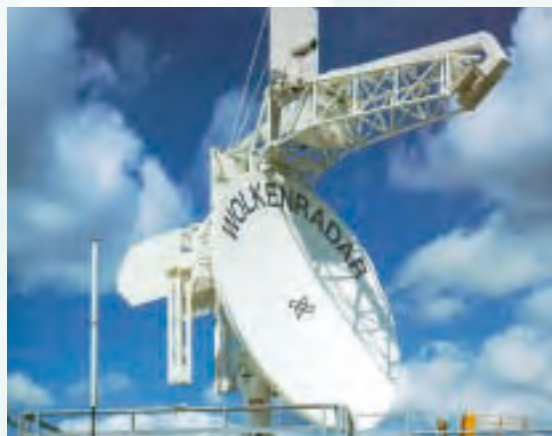
Das Wolkenradar hilft Art und Menge von Niederschlags- teilchen wie Regentropfen, Schnee, Graupel oder Hagel zu bestimmen.
