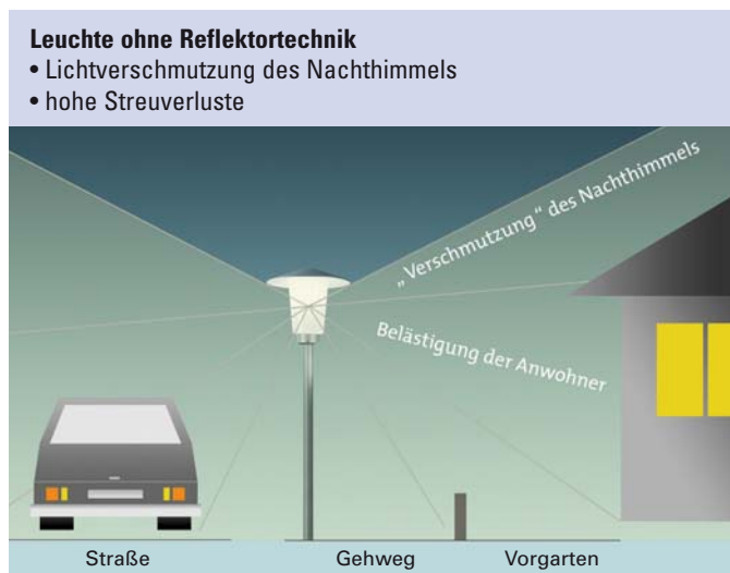
Leuchten mit und ohne Reflektortechnik Grafik: SITECO
