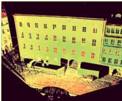
Abb. 5-3 Punktwolke einer Fassade
