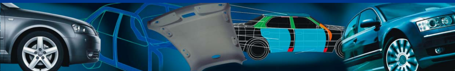
Abb. PET-Prototypen und Serienhimmel bewirken im Mittel eine Reduzierung des Schalldruckpegels in der Fahrgastzelle von etwa 3 dB(A).
