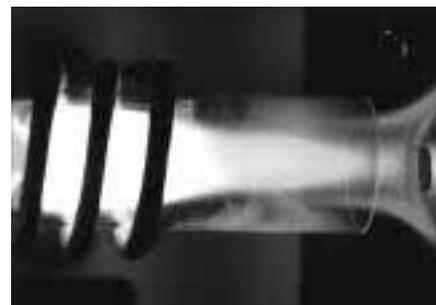
Induktiv gekoppeltes Plasma (ICP)
