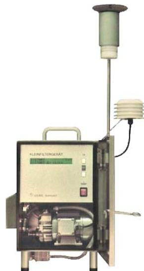
Abbildung 1: Low Volume Sampler LVS3 der Firma Leckel
