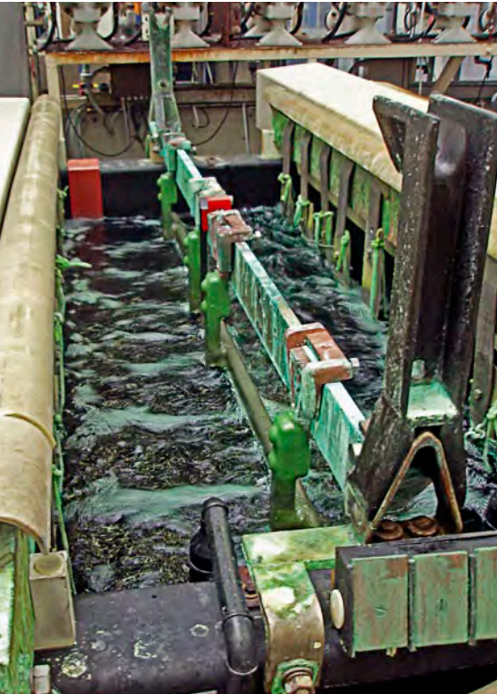
Nickelbad in einer Galvanisieranlage
