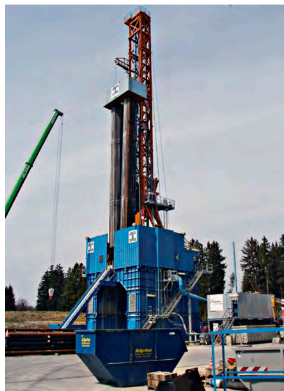
Geothermiebohrplatz, um heißes Grundwasser aus großer Tiefe für die Strom- und Wärme Gewinnung zu erschließen
