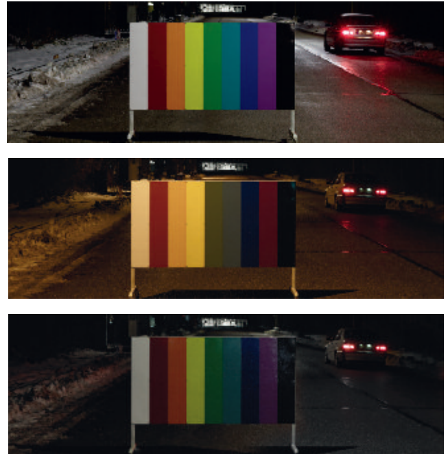
Vergleich der Farbwiedergabe: neutralweiße LED, HS-Lampe und HM-Lampe (von oben nach unten); Fotos: Siteco
