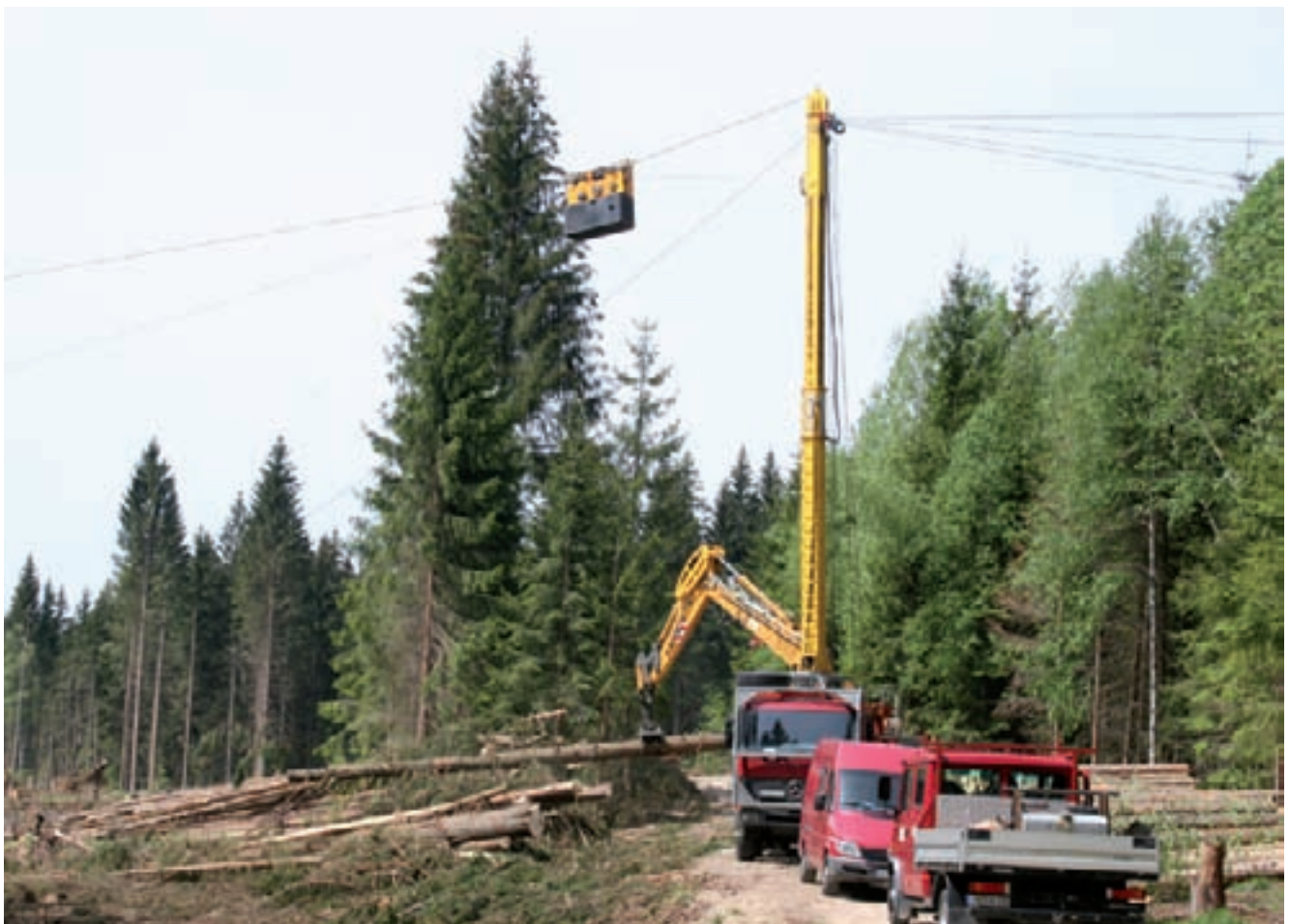
Um die vorhandene Naturverjüngung zu schonen, wurde zur Aufarbeitung von Borkenkäferholz eine Seilkrananlage eingesetzt (Foto: R. Pöhlmann).
