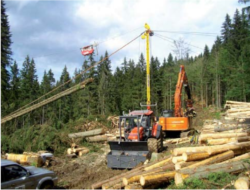
Bild 12: Mit Seilkrananlagen werden die befällenen Bäume auf empfindlichen Böden an die Rückewege transportiert. Foto: Franz Baierl
