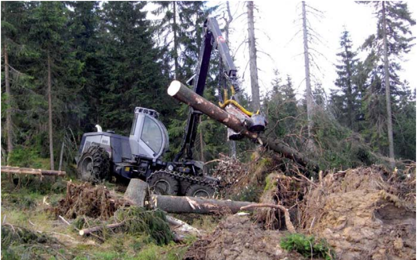
Bild 11: Vollerntemaschinen, sogenannte Harvester, werden bei großflächigen Borkenkäferbefall oder Windwürfen eingesetzt. Foto: Franz Baierl
