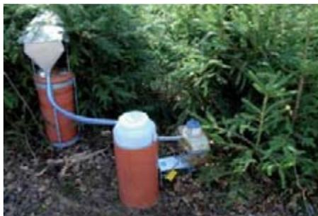
Messung der Niederschlagsintensität
