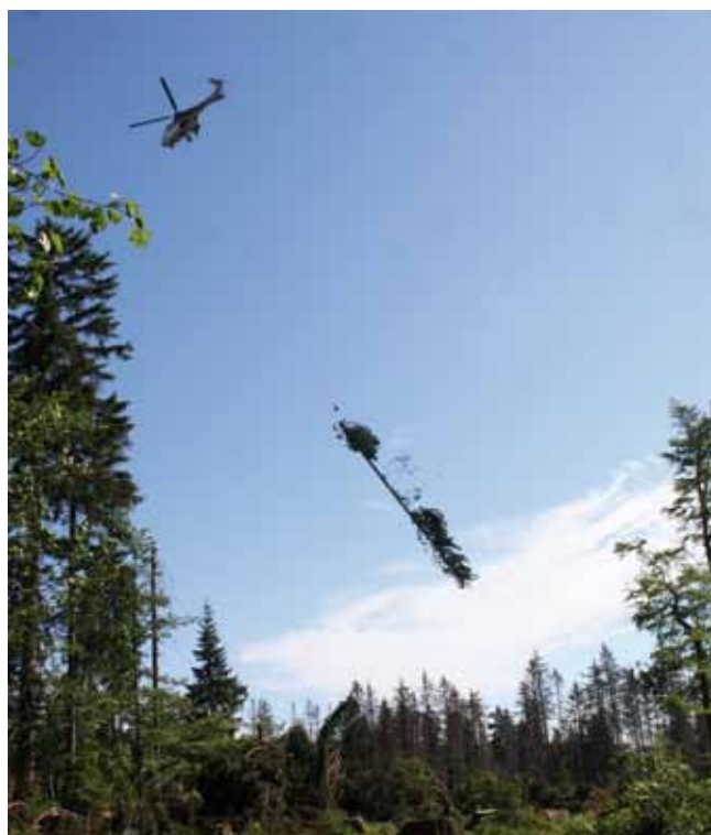
Einsatz eines Speziallasten-Hubschraubers zur Holzbringung (Foto: F. Baierl).
