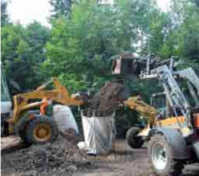
*Beladen eines Transportbehälters: Eine Lademaschine hält den Transportsack geöffnet. Die Schlaufen des Sacks sind dabei auf die Zinken einer Ladegabel geschoben. Die andere Maschine füllt Hackschnitzel ein.*
