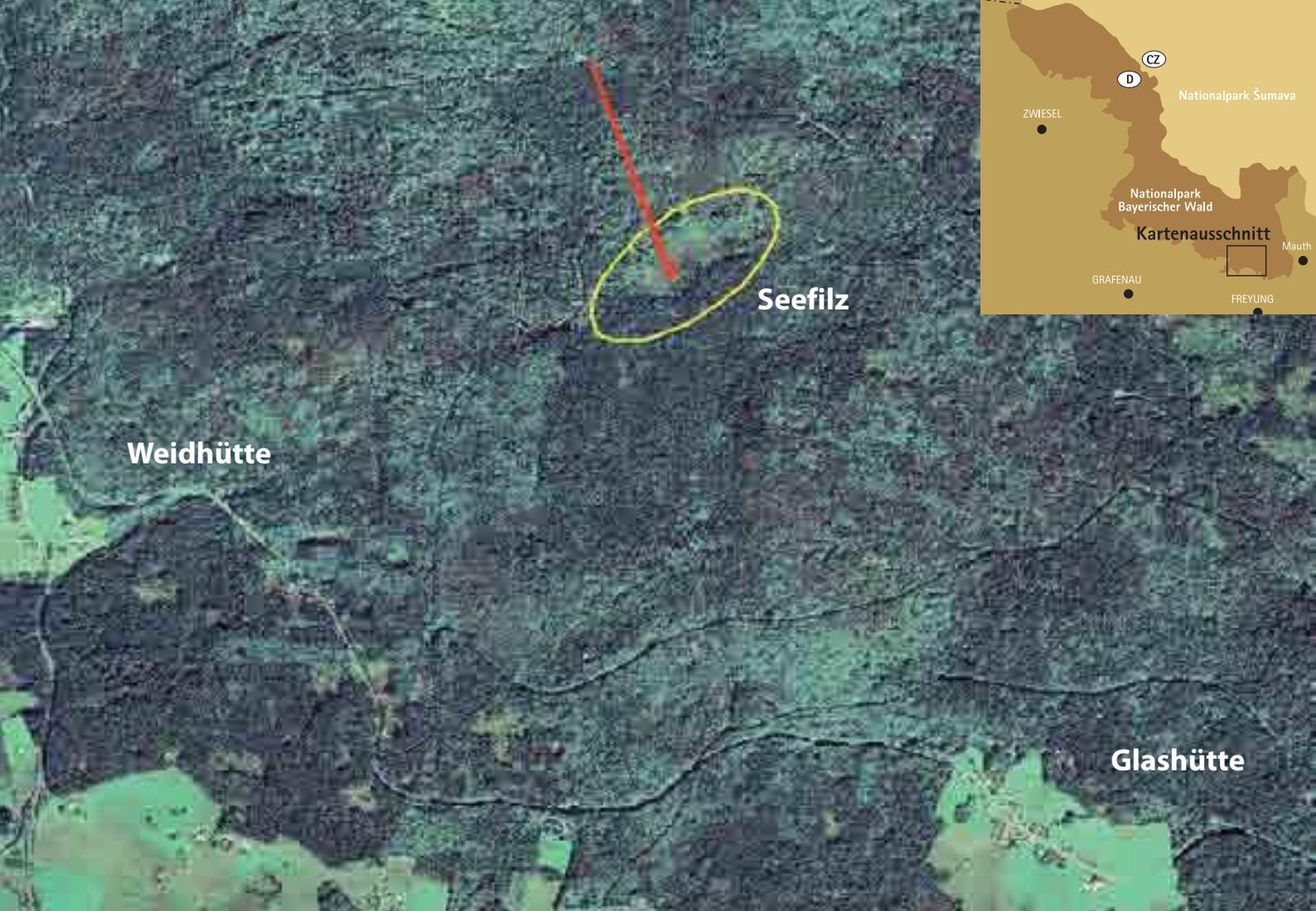
Der rote Pfeil markiert die Flugroute vom Hackschnitzelbeladeplatz auf der sogenannten „Bärnautlinie“, einer Forststraße, zum Seefilz. Die Entfernung zwischen Beladeplatz und Abladestelle beträgt Luftlinie 800 Meter. Die Flugzeit zwischen Beladung, Abladen und Rückkehr zum Beladeort betrug im Schnitt zwischen fünf und sechs Minuten.
