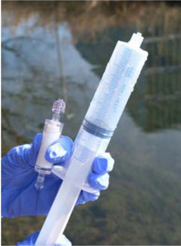
Abbildung 17: links: Einwegspritze; rechts: Aufsetzen der Filterkapsel. © Pawlowski et al. 2020
