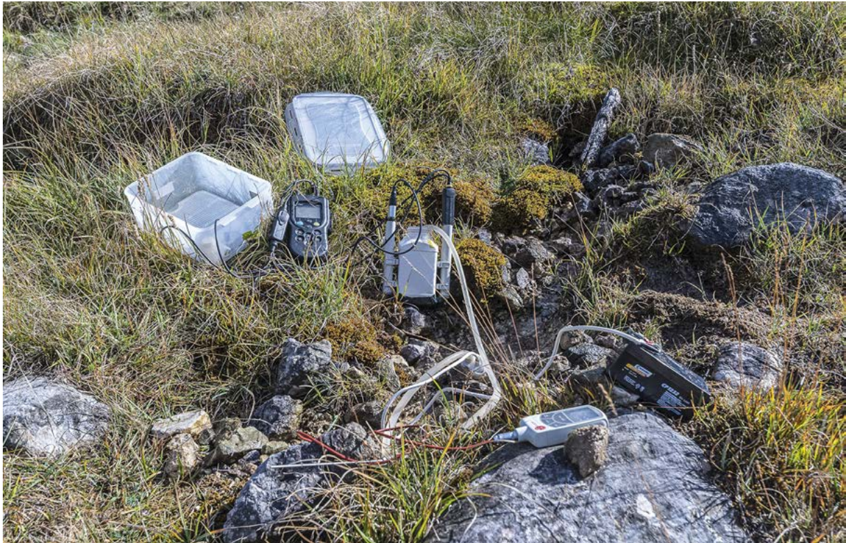
Abbildung 12: Messung der in situ-Parameter im Gelände mit einem beispielhaften Multisondengerät. © Nationalparkverwaltung Berchtesgaden
