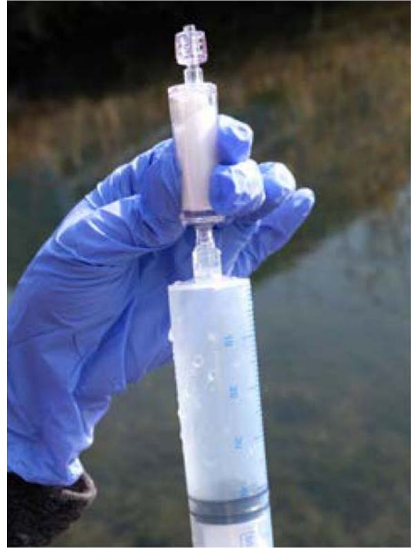
Abbildung 17: links: Einwegspritze; rechts: Aufsetzen der Filterkapsel. © Pawlowski et al. 2020
