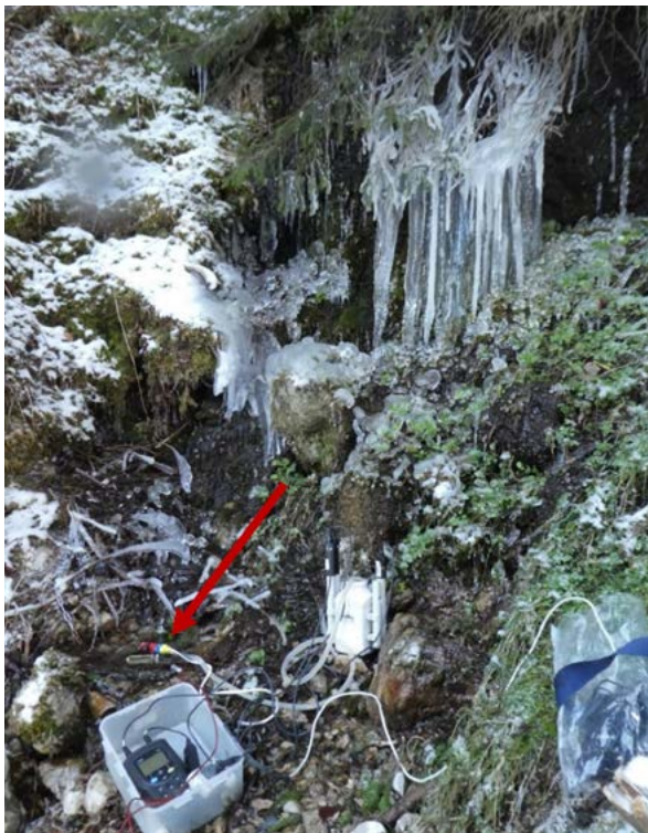
Abbildung 9: Einsatz einer Durchfluspumpe (durch roten Pfeil markiert) im Gelände im Nationalpark Berchtesgaden, um die Messsonden konstant mit Wasser bedeckt zu halten. © Nationalparkverwaltung Berchtesgaden
