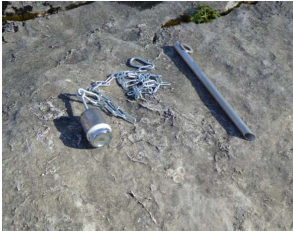
Abbildung 10: Metallstab, Kette und Metallkörnchen zur Fixierung und zum Schutz des Datenloggers gegen Geschiebefracht. © Nationalparkverwaltung Berchtesgaden
