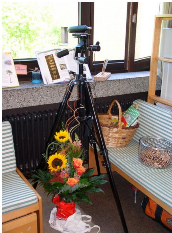
Abbildung 5-5: Schallpegelmessgerät und fixierte Personendosimeter während der Validierungsmessung
