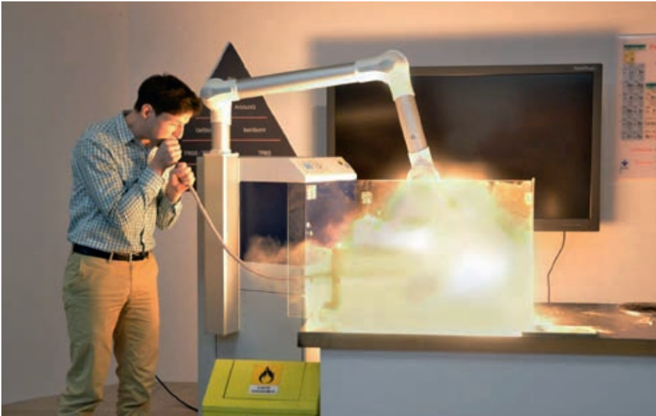
Abbildung 3: Explosionshäuschen und Absauganlage mit Staubexplosion
