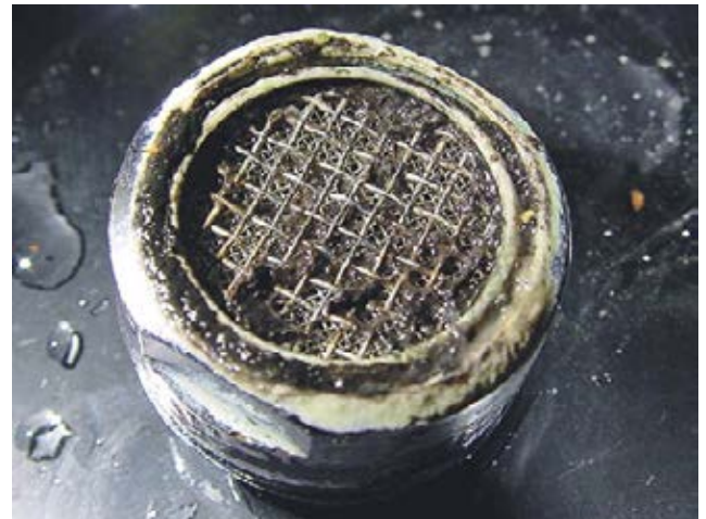
Abbildung 1: In diesem Biofilm am Strahlregler eines Wasserhahns können Legionellen geschützt wachsen.
