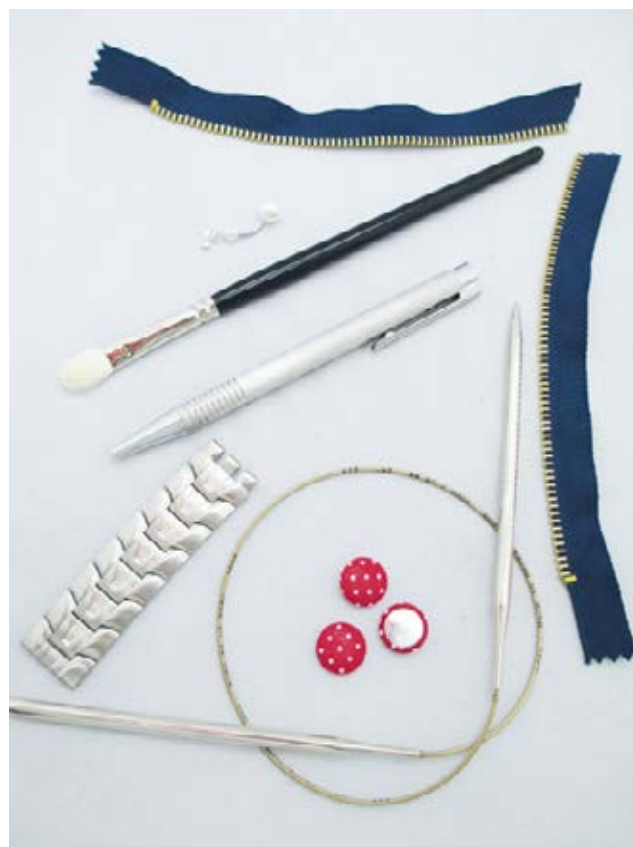
Abbildung 3: Neben Schmuck standen weitere Gegenstände mit Körperkontakt zur Nickeluntersuchung auf dem Probenplan.
