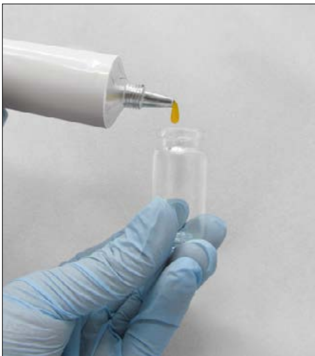
Abbildung 7: Probenvorbereitung zur Untersuchung von Klebstoff
