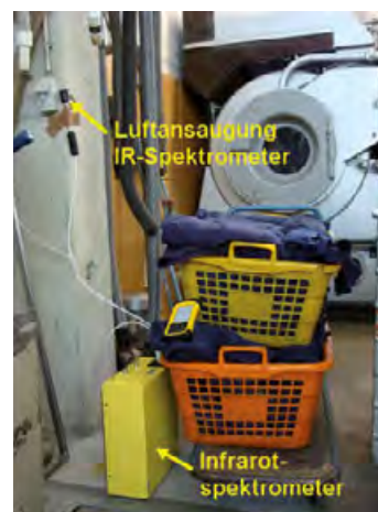
Abbildung 11: Messung der PER-Konzentration in der Luft im Arbeitsbereich des Reinigungsanlagenbedieners mit dem tragbaren Infrarotspektrometer
