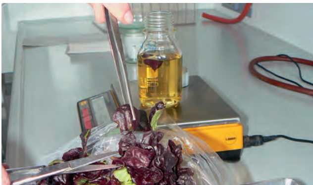
Abbildung 9: Eichblattsalat wird für die mikrobiologische Untersuchung zerkleinert und mit einer Pinzette in eine Anreicherungsbouillon für Mikroorganismen eingewogen.
