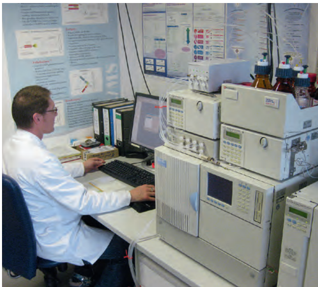
Abbildung 26: Zur chemischen Untersuchung von Antibiotikarückständen in Muskel- bzw. Nierenproben setzt das LGL ein LC-MS-Analysesystem ein.
