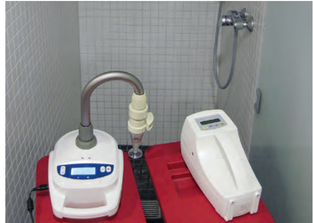
Abbildung 15: Mittels eines Cyclon-Abscheiders (links) und eines Luftkeimsammlers (rechts) wurden legionellenhaltige Aerosole gesammelt.
