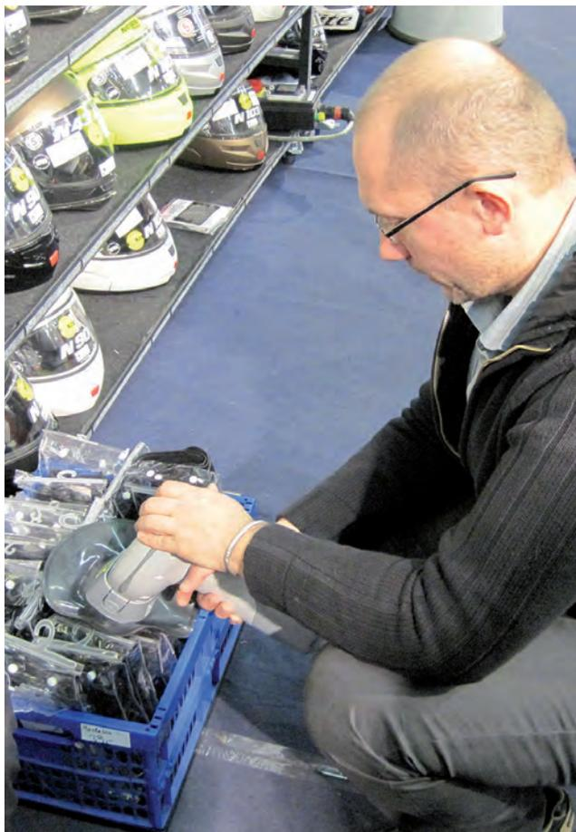
Abbildung 2: Untersuchung mittels RFA-Messgerät vor Ort
