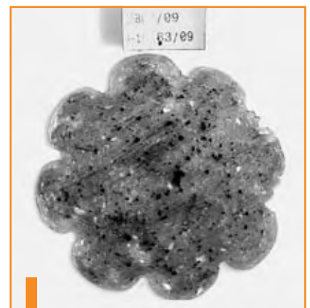
Abbildung 2.3e: Mit Jodlösung lassen sich die Reiskörner nachweisen (Schwarzfärbung durch Reisstärke)
