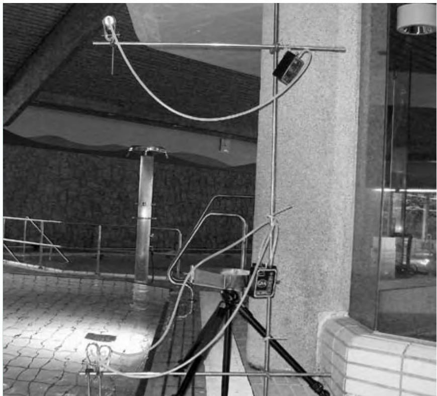
Abbildung 5.1a: Aufbau des Probennahmesystems
