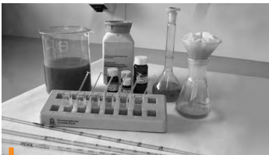
Abbildung 3.2.5a: Das LGL untersucht Suppen und Soßen, hier eine Tomatensuppe, mittels enzymatischer Bestimmung auf Glutamat.
