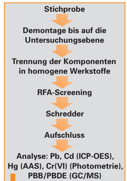
Abbildung 4.6b: Analyse der Proben nach den Normen IEC 62596 und IEC 62321
