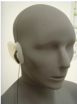
Abbildung 4: Der Kunstkopf der ZPG misst die Schallpegel, die im Ohr ankommen.
