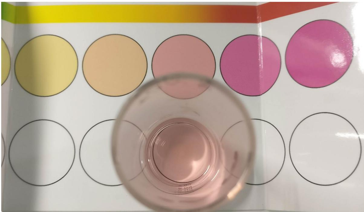
Abbildung 9: Kolorimetrische Bestimmung von Wasserparametern
