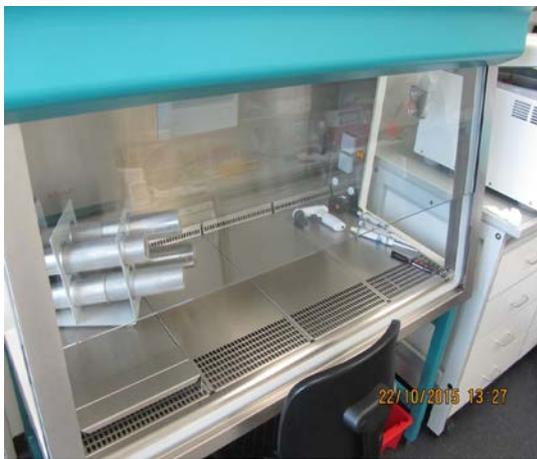
Abbildung 1.5: Die Luftauslässe auf der Sicherheitswerkbank und die Lüftungsschlitze in der Selbigen sind unbedingt frei zu halten.
