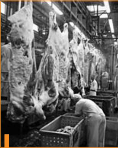
Abbildung 2.1c: Rinderschlachtband (Bearbeitung Halspartie)
