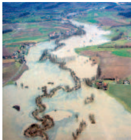
Bei Hochwasser wird die Talau überschwemmt. Die Bäume ragen noch aus dem Wasser und markieren das Flussufer. Der Talraum dient als Retentionsfläche – Roter Main, Januar 2002.
