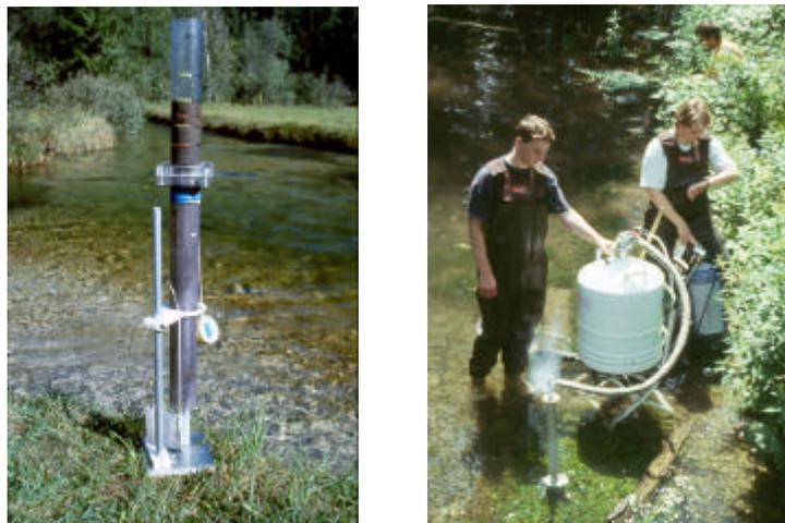
Abb. 4: Sedimentstechrohr, aufgesetzt auf Schieber zur Abmessung der obersten 15 cm (links) und Freeze-Corer im Einsatz (rechts)
