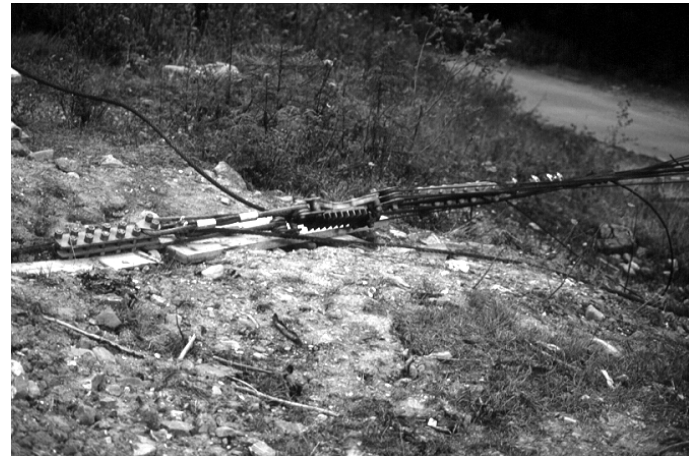
Abb. Flaschenzug mit Klemmplatte, das Tragseil führt von der Klemmplatte zum eingegrabenen „Toten Mann“
