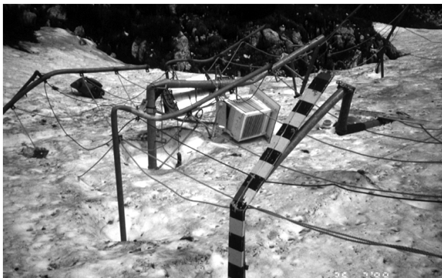
Abb. Von Großlawine zerstörte Messstation des Bayerischen Lawinenwarndienstes
