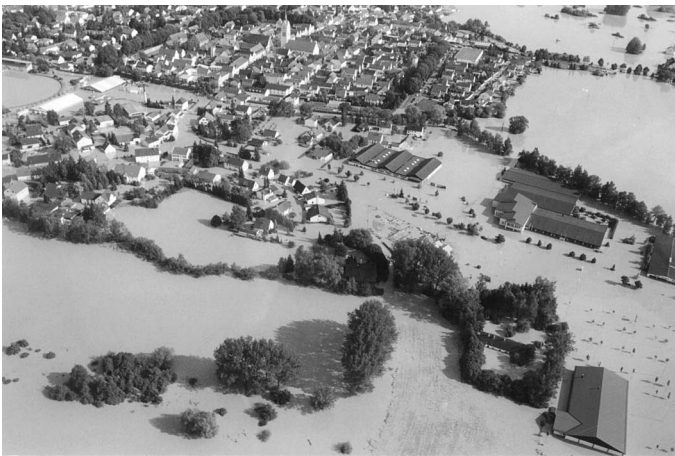
Abb. 9 In Neustadt a. d. Donau wurde nach dem Deichbruch das gesamte Poldergebiet bis zu 2 m hoch überflutet. Zahlreiche Öltanks schlugen leck, so dass insgesamt mehr als 2 Mio Liter Heizöl austraten
