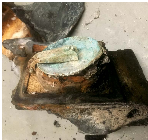
Abb. 18 (links): Marode Rückstauklappe nach 40 Jahren ohne Wartung Abb. 19 (rechts): Dränleitung auf einer Baustelle
