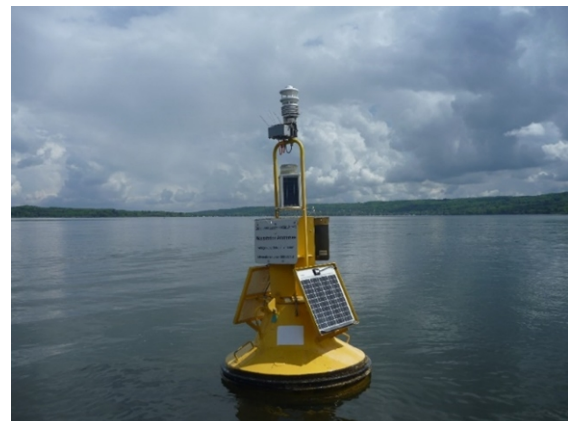
Abbildung 11: Messstation im Ammersee mit Kompaktklimastation (oben) und Solarpanelen zur autarken Stromversorgung (seitlich). © BLfU
