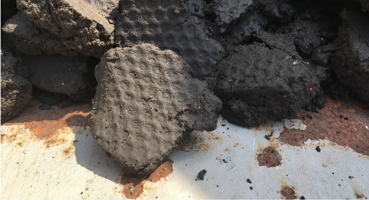
Abb. 9: Klärschlamm aus der Entwässerung mit einer mobilen Kammerfilterpresse
