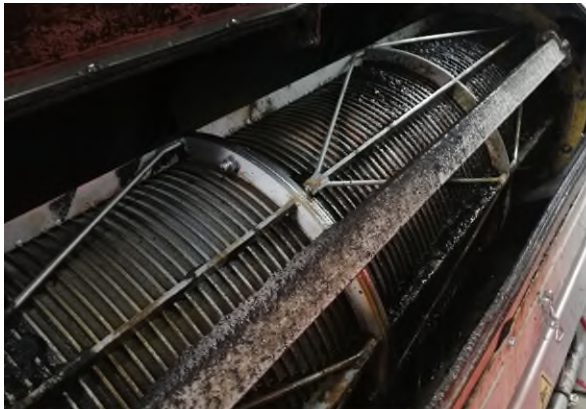
Abb. 8: Klärschlammmentwässerung durch Schnecken- ... und Kammerfilterpresse- presse...
