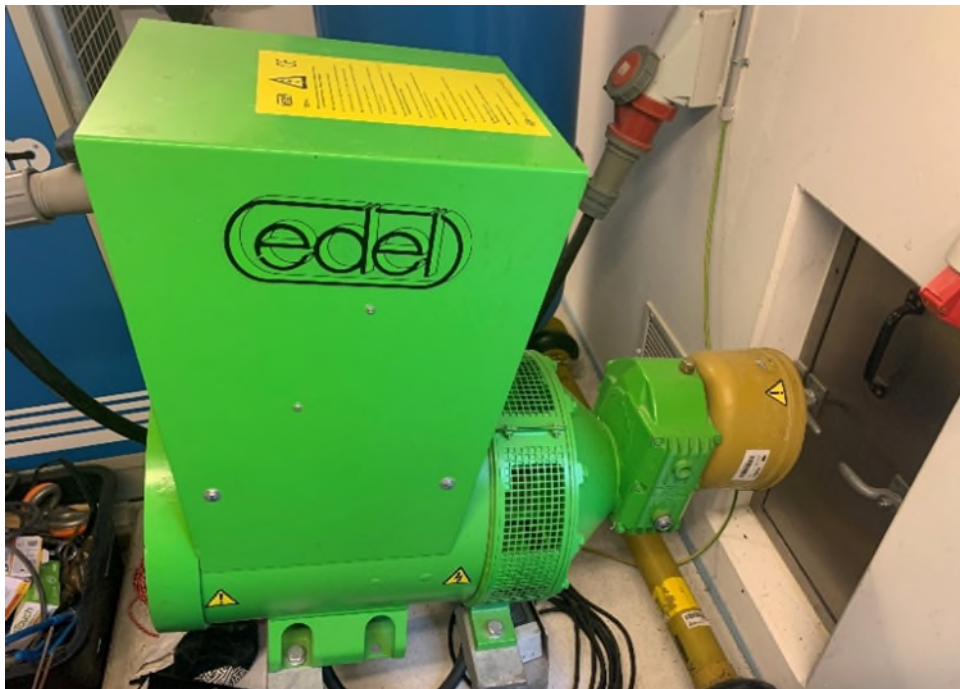
Abb. 1: Zapfwellengenerator zum Betrieb am Neben- antrieb einer landwirt- schaftlichen Zugma- schine
