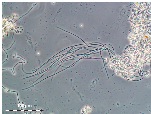
Abb. 8.59: Scheinverzweigte Fäden wachsen aus der Flocke heraus (PH, 200×).
