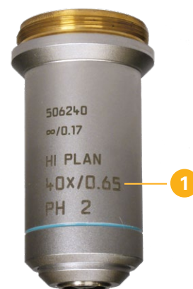
Abb. 3.2: Objektiv mit Beschriftung; Objektivvergrößerung und numerische Apertur (1)
