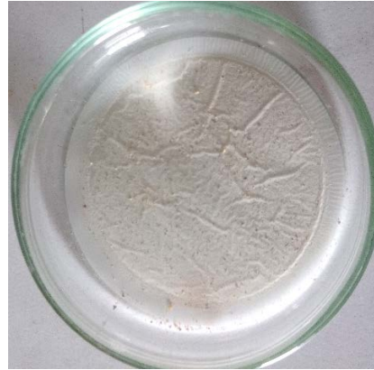
Abb. 6: Probenfilter in Transport-Pet- rischale vor Behandlung mit Isopropanol
