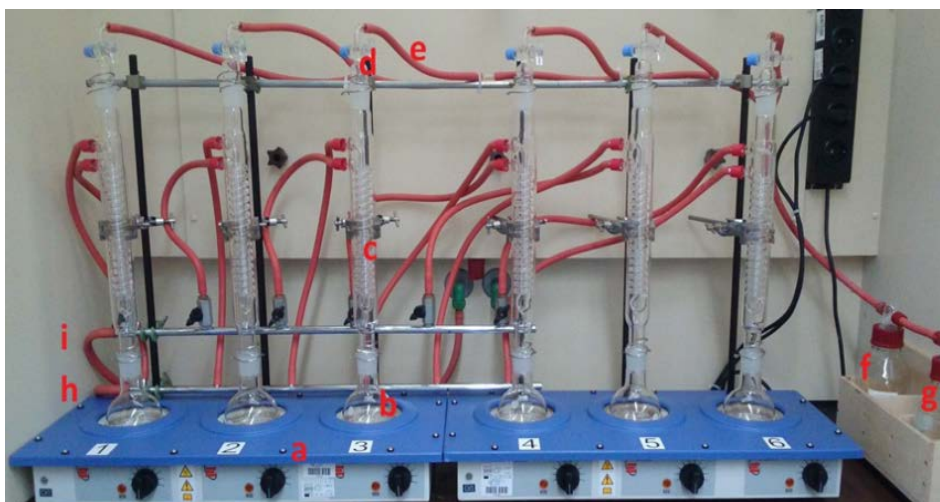
Abb. 5: Aufbau für den Säureaufschluss: a) 3-fach Gewebeheizer, b) Rundkolben, c) Rückflusskühler, d) Übergangsstück, e) Gasabführung, f) Waschflasche mit Natronlauge, g) Waschflasche mit Wasser, h) Kühlwasserzulauf, i) Kühlwasserablauf
