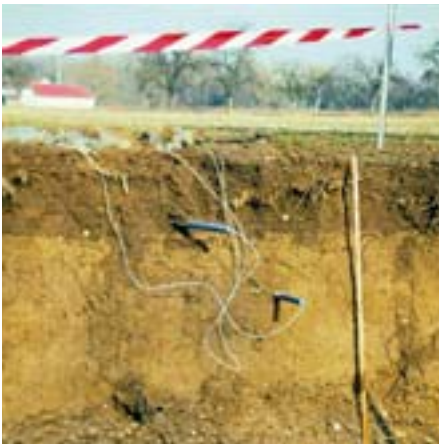
▲ Grundwasser aus gut geschützten Brunnen liefert in Bayern den größten Teil des Trinkwassers (Bild oben). Mit Hilfe so genannter Saugkerzen wird das im Boden versickernde Wasser auf Nitrat und andere gelöste Stoffe untersucht (Bild unten).
