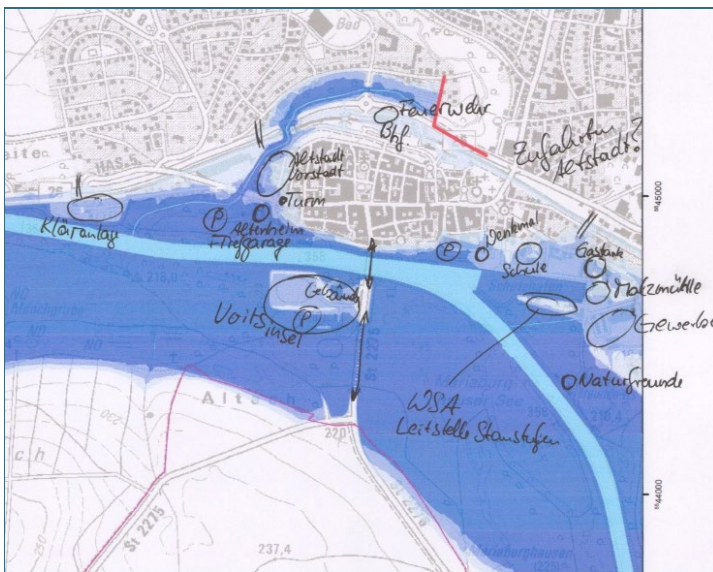
Abb. 2: Dokumentation der Risikosituation in einer Hochwassergefahrenkarte des 1. Bearbeitungszyklus
