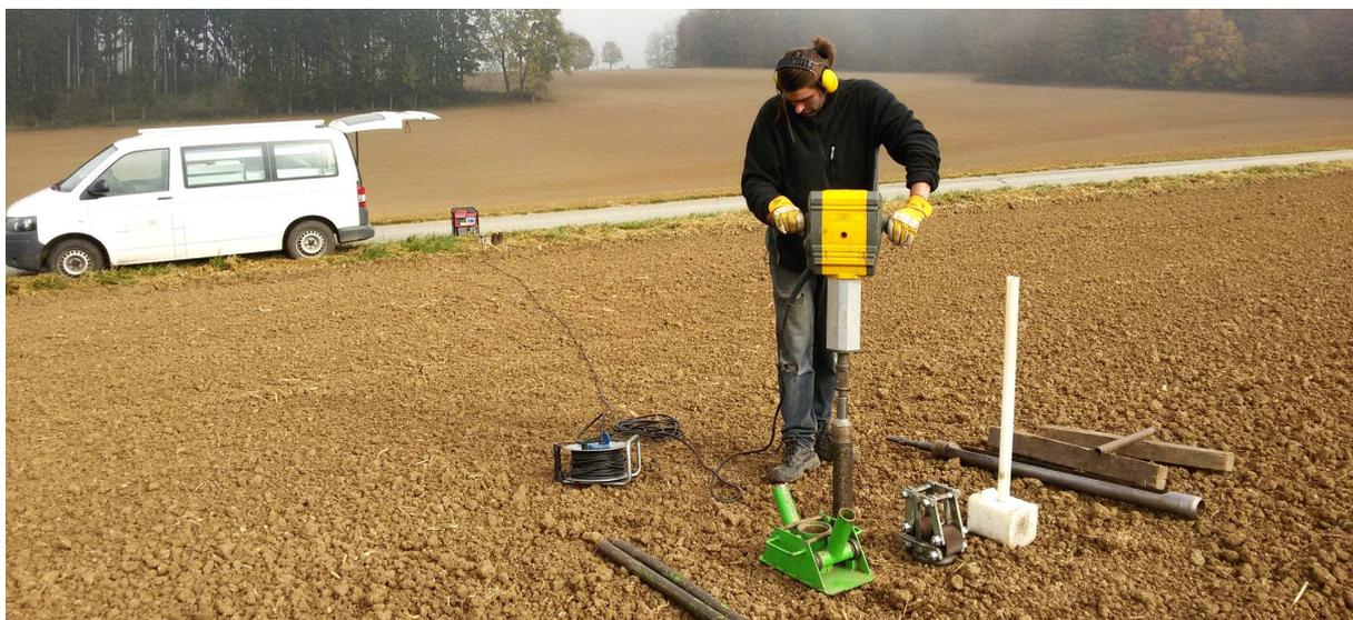
Abb. 20: Rammkernsondierung bei Auhof
