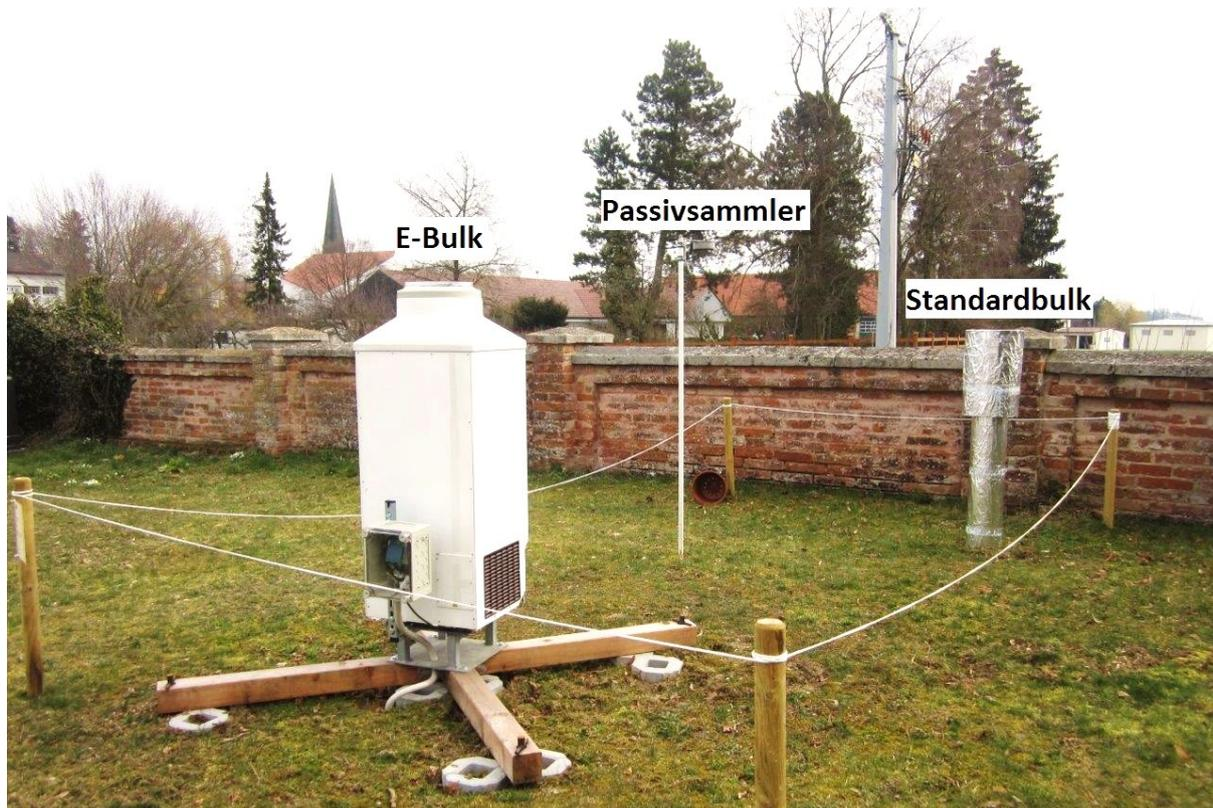
Abb. 19: Messstandort in Hohenthann mit E-Bulk, Standardbulk und Passivsammler
