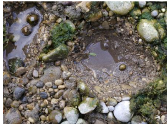
Abb. 33: Grobsediment, keine äußere und mäßige innere Kolmation (Beispiel 2)
