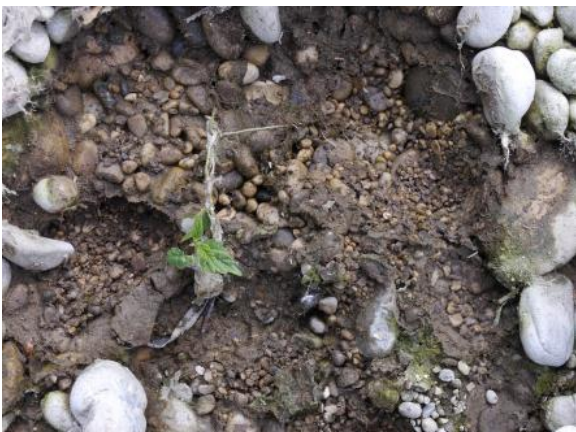
Abb. 34: Grobsediment, keine äußere und ausgeprägte innere Kolmation
