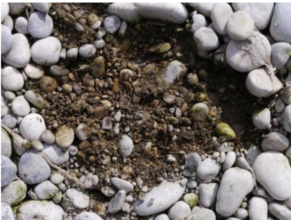
Abb. 32: Grobsediment, keine äußere und mäßige innere Kolmation (Beispiel 1)
