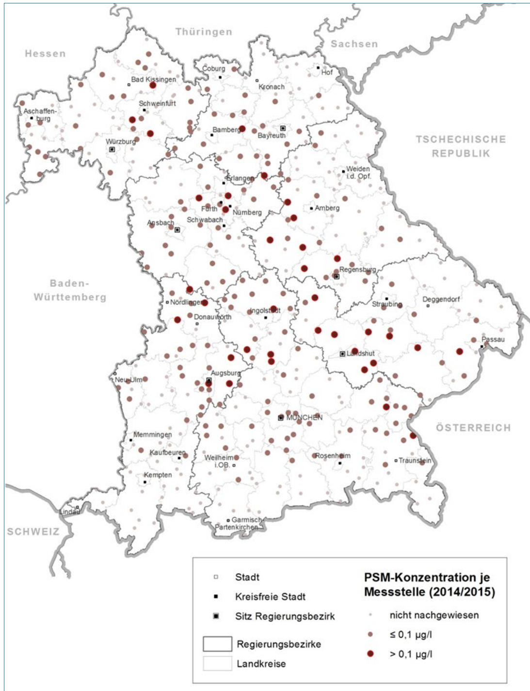
Abb. 23: PSM-Konzentrationen im Grundwasser von 445 untersuchten Messstellen des WRRL-Überblicksmessnetzes; Analysedaten aus den Jahren 2014 und 2015 (Basis: alle PSM-Wirkstoffe und relevante Metabolite)
