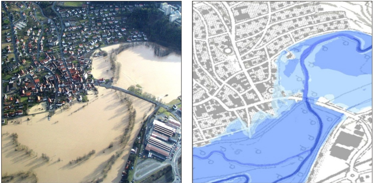
Realität und Modellierung: Luftbild eines hochwasserführenden Gewässers und der dazugehörige Ausschnitt einer Hochwassergefahrenkarte
