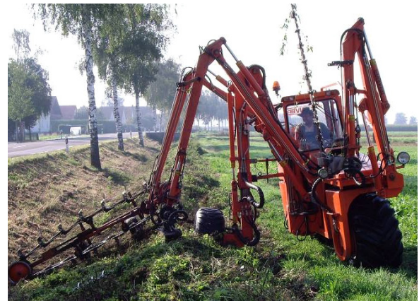
Deutlich effektiver aber weniger naturverträglich sind Kombinationsgeräte, die mehrere Arbeitsgänge gleichzeitig verrichten. (Foto: P. Kober)
