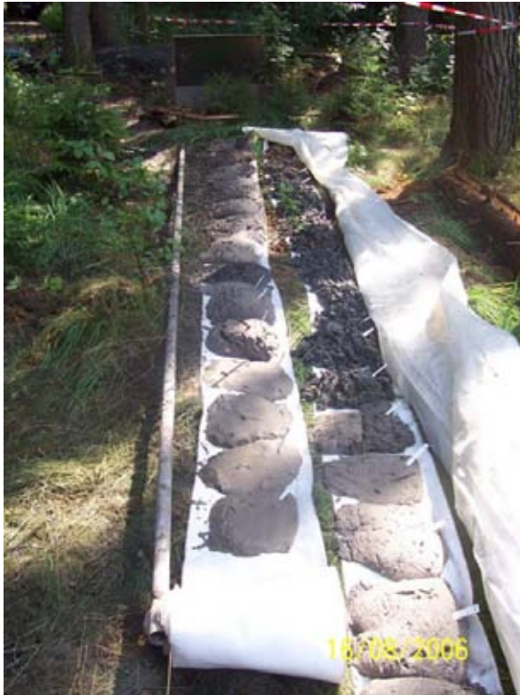
Ausgelegte Proben an einer Spülbohrung
