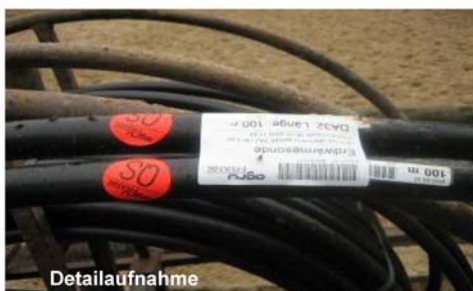
Werksgefertigte ausreichend deklarierte Sonde
